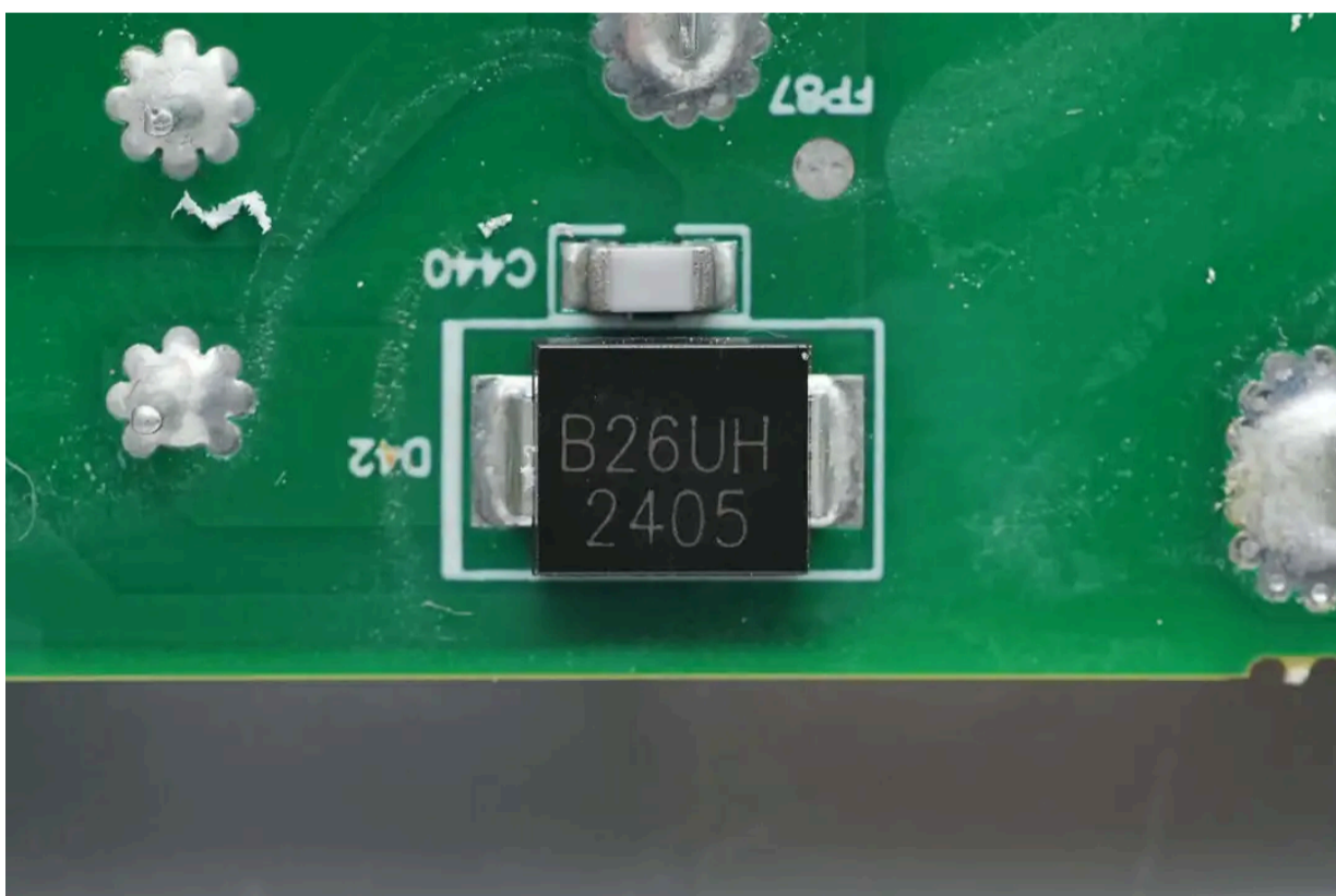
PCBA模块背面还设有一颗同型号的TVS二极管。
